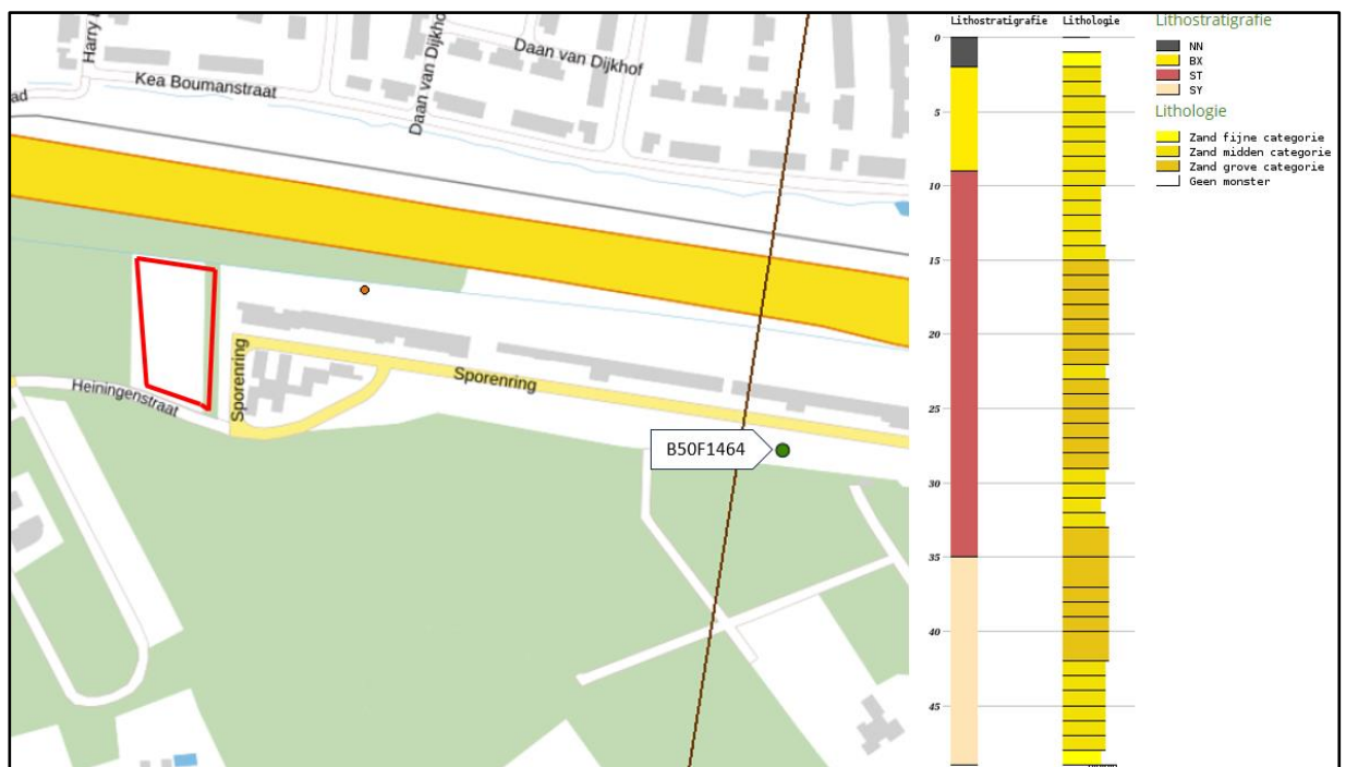
Figuur 2-5: Grondboring B50F1464 locatie en boormonsterprofiel (bron: DINOloket).
